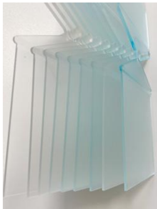
Obr. 3 Rychlá změna barvy při použití CEVO®-clean 1823/PMMA (1:4). Viz také tab. 1..
