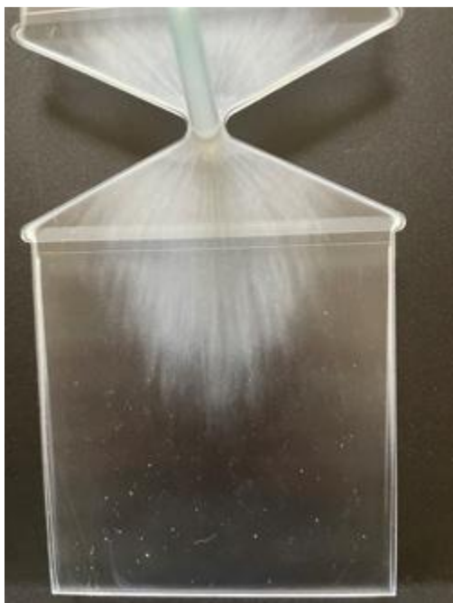
Obr. 2 Konkurenční produkt: Šmouhy čistícího prostředku na deskách – i po propláchnutí PMMA.
